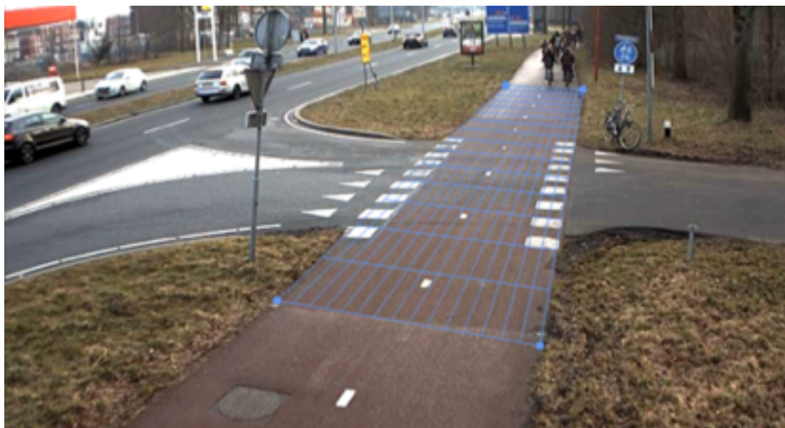
Afbeelding 2.2: Het Kinovea-raster geprojecteerd op de camerabeelden van Biltse Rading met zijweg Manegelaan
